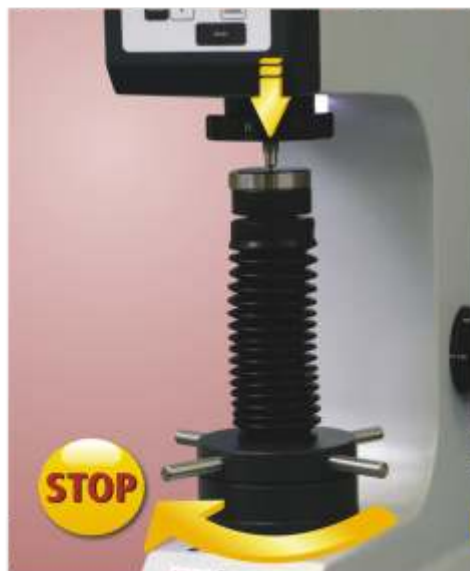
Pré-Carga com Freio Eletromagnético
