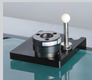
Master ball (opcional) Usada para compensação do diâmetro da ponta.
