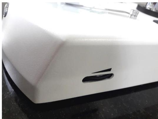
**\*\*Isto deve ser repetido toda vez que o estereomicroscópio for ligado ou desligado, para prolongar a vida útil do bulbo.\*\***
