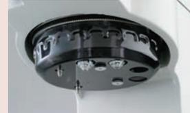
Torre motorizada. Se pueden montar simultáneamente hasta cuatro objetivos y dos penetradores.
